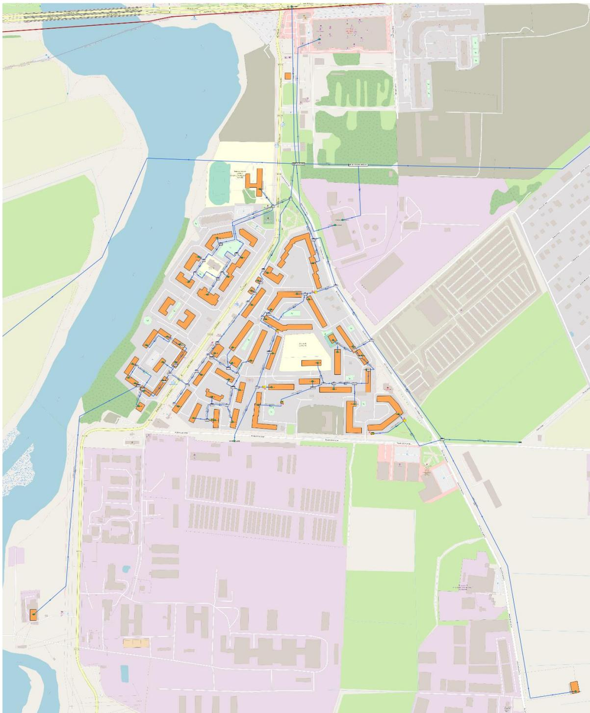
Рисунок 3 Сети технологической зоны холодного водоснабжения №1
